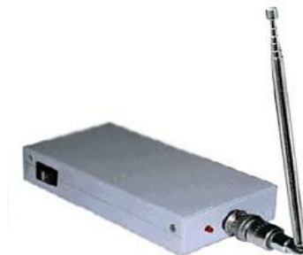
Рис. 6. Генератор шума SEL SP-21B1 Баррикада-1 (диапазон частот 5,0-1000 МГц )
