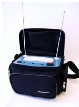
Рис. 10. Генератор шума Штора-2 и Штора-4 (диапазон частот 1000-2000 МГц и 0,1-2500 МГц )
