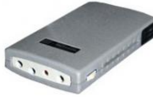
Рис. 11. Подавитель устройств Bluetooth и WiFi (предназначен для блокировки работы устройств несанкционированного прослушивания, передачи данных, а также для блокирования работы радиопередаточных устройств, работающих в стандартах Bluetooth и WiFi. Диапазон частот 2400-2483,5 МГц)
