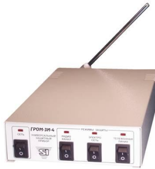
Рис. 8. Генератор шума Гром-ЗИ-4 (предназначен для создания шумовой помехи по радиоканалу, телефонной линии и электросети для блокировки несанкционированно установленных устройств, передающих информацию)
