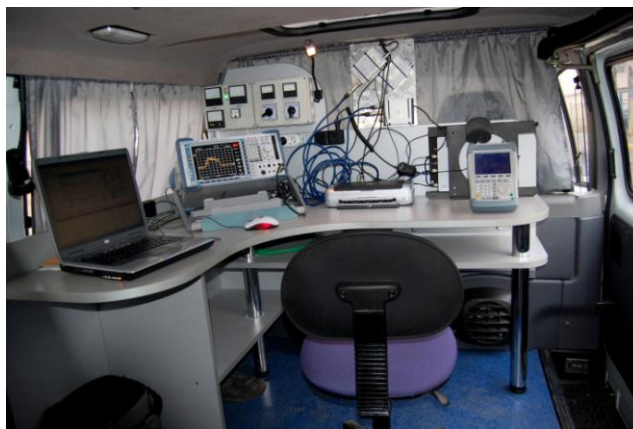
Рис. 6. Внутренний вид салона подвижного комплекса
