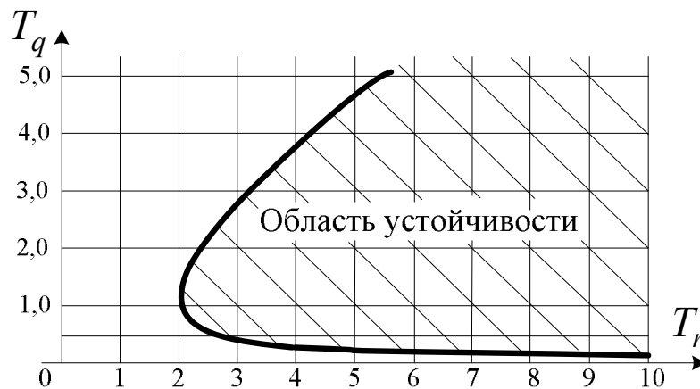
Рис. 7. Граница области устойчивой работы стабилизатора непрерывного действия с параллельным включением регулирующего элемента.
