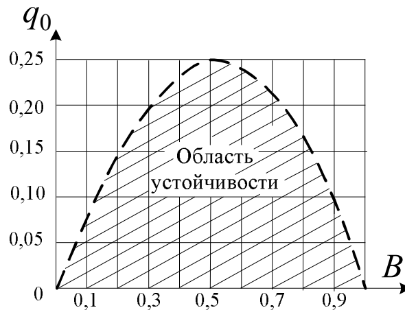
Рис. 8. Граница области устойчивой работы стабилизатора непрерывного действия с последовательным включением регулирующего элемента.
