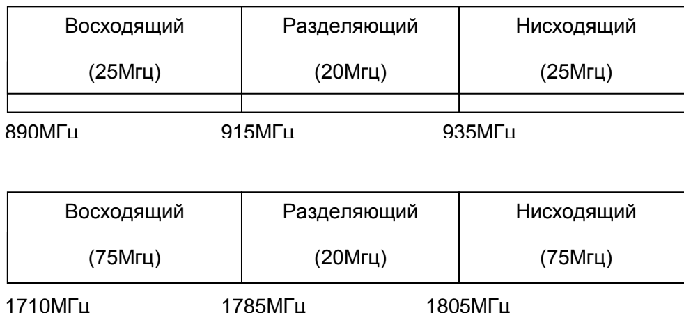
Рис. 1. Распределение частот в стандартах GSM900 и GSM1800
