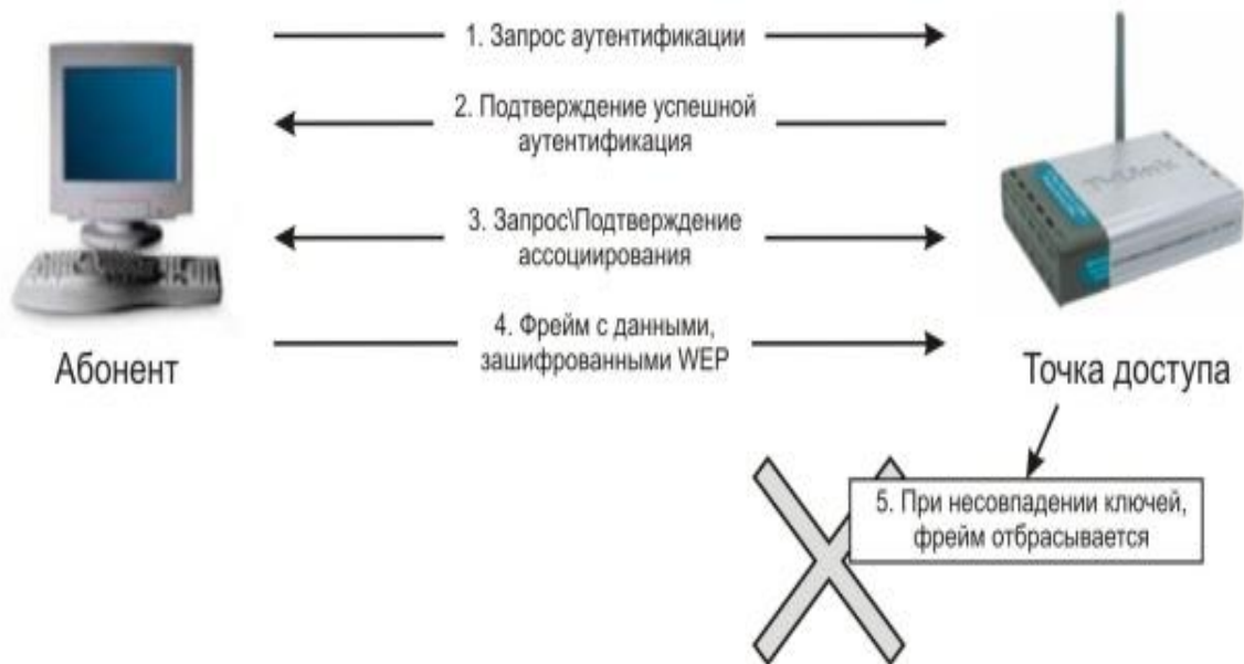
Рис. 2. Схема включения при открытой аутентификации
