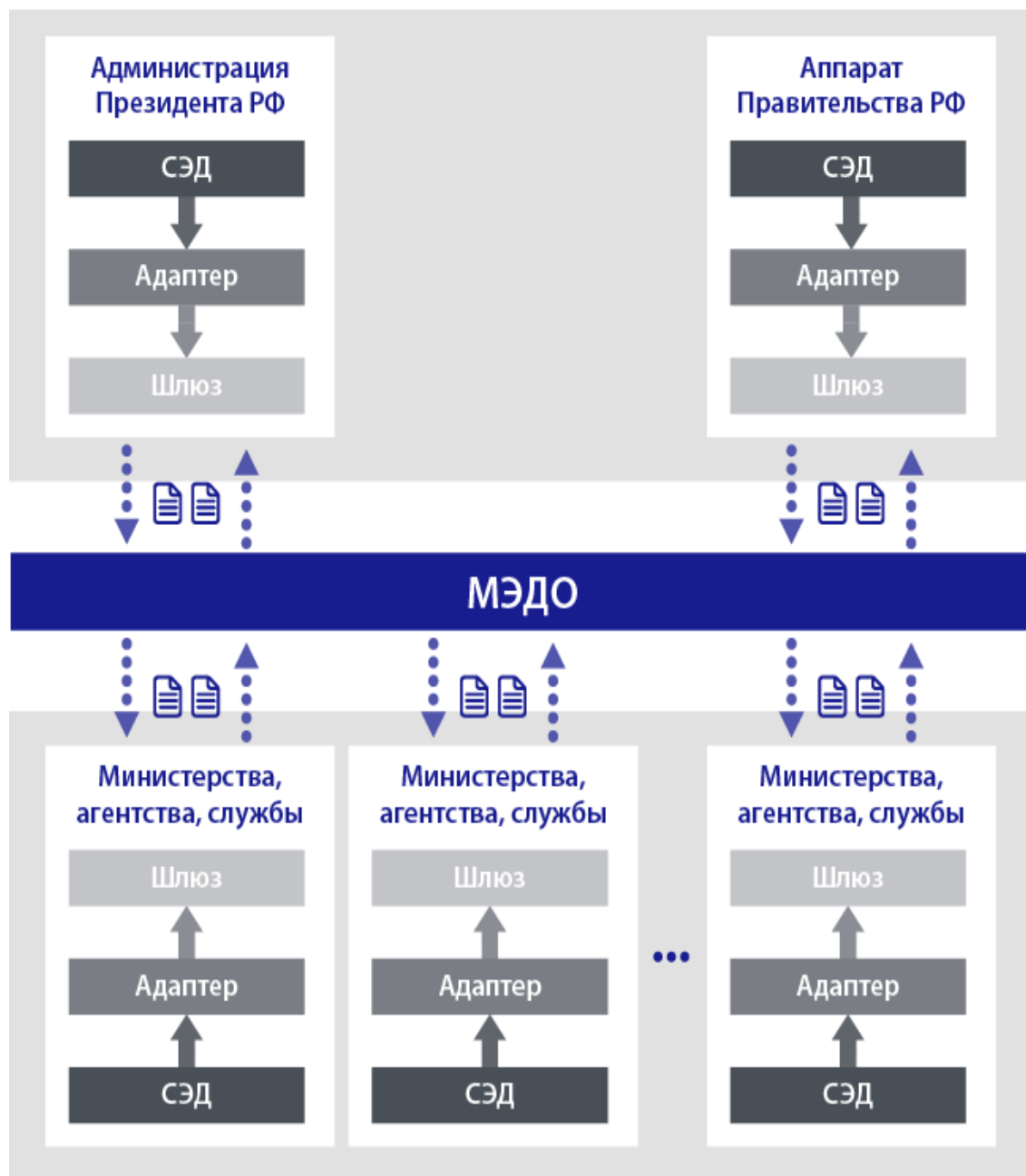
Рисунок 2 - Архитектура решения МЭДО
